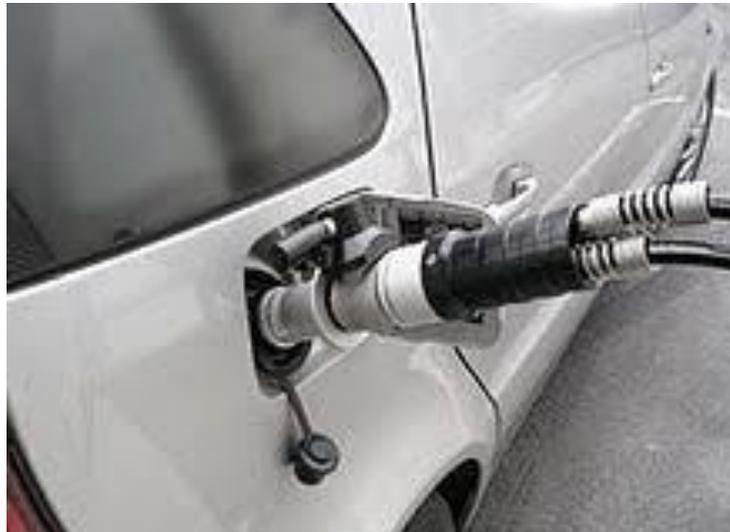
Durante il processo di ricarica di idrogeno, viene creata una tenuta di gas e il rifornimento è bloccato se la tenuta cede. Nel rifornimento di benzina non ci sono controlli per prevenire la fuoriuscita di combustibile.
